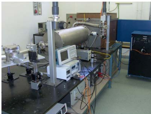
Diagnosztika: JOBIN YVON TGS 300 (10-110 nm), XRD, foszforfilm, MCP-CCD, Rogowsky
